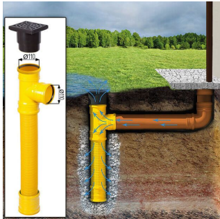
Sickerschacht mit Zufluss/Abfluss Ø 110 mm
