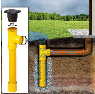
Sickerschacht mit Zufluss/Abfluss Ø 110 mm
