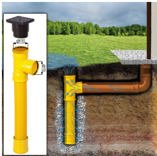
Sickerschacht mit Zufluss/Abfluss Ø 110 mm
