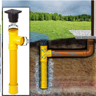
Sickerschacht mit Zufluss/Abfluss Ø 110 mm
