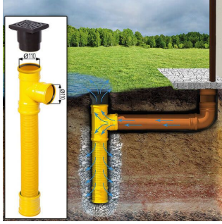
Sickerschacht mit Zufluss/Abfluss Ø 110 mm
